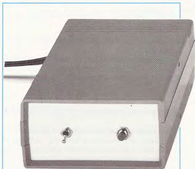
Fig.1 Questo progetto andrà racchiuso entro un elegante mobile plastico. Nel pannello anteriore sono inseriti l'interruttore di accensione ed il pulsante P1, che vi sarà utile per controllare periodicamente il funzionamento dell'antifurto.
