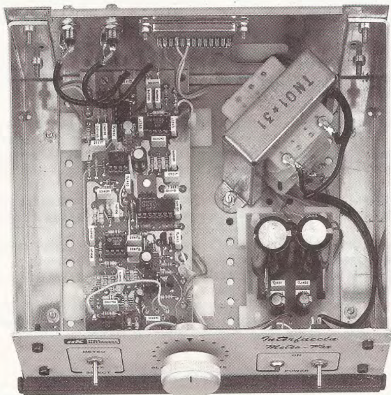
Fig.4 In questa foto potete vedere come andranno disposti i due circuiti stampati ed il trasformatore di alimentazione all'interno del mobile.
